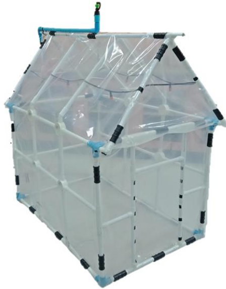
ภาพที่ 1 โรงเรือนจำลองขนาด ขนาด 70 x 100 cm
