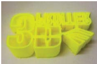
รูปที่ 3 ชิ้นงานที่มีลักษณะเป็นโพรงด้านใน
