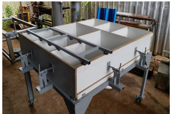
ภาพที่ 6 โครงสร้างของอุปกรณ์จับยึดสำหรับชุดชิ้นวางบน
