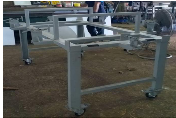
ภาพที่ 5 โครงสร้างของอุปกรณ์จับยึดสำหรับชุดชิ้นวางโค้งหน้า
