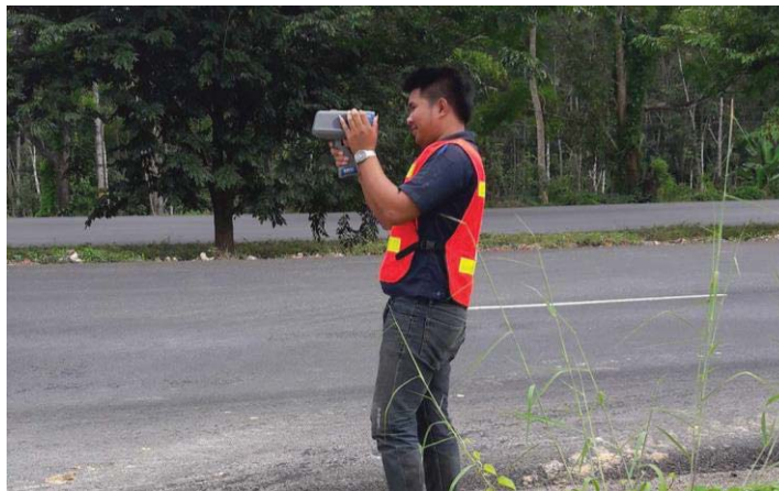
ภาพที่ 2 การวัดความเร็วรถยนต์ในเขตก่อสร้าง
