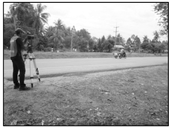
รูปที่ 2 การใช้เครื่องมือ TRU ANGLE ในการบันทึกข้อมูลร่องรอยการเกิดอุบัติเหตุ
