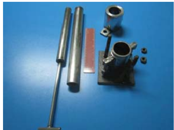
รูปที่ 2 Mini Compactor ที่ใช้ในการเตรียมตัวอย่าง
