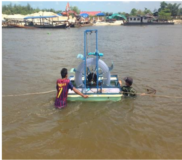
รูปที่ 2 ทดลองกังหันสูบน้ำท่อขดกันหอยที่แม่น้ำปากพนัง
