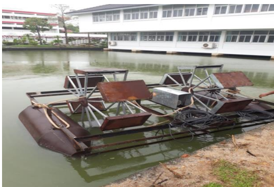
รูปที่ 1 กังหันเดิมอากาศด้วยพลังงานแสงอาทิตย์
