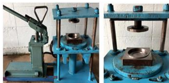
ภาพที่ 4.1 ประกอบแม่พิมพ์โลหะเข้ากับเครื่องอัดไฮดรอลิกส์
