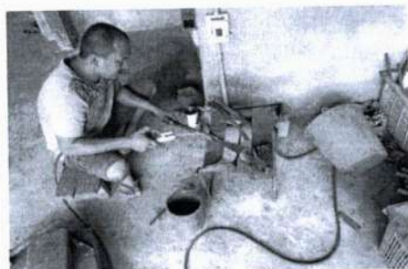
ภาพที่ 7 การเชื่อมด้ามให้ติดกัน
