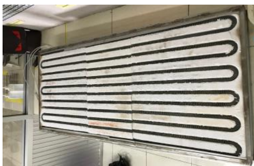
ภาพที่ 8 ฮีตเตอร์ที่ให้ความร้อนด้วยขดลวดไฟฟ้า (electric heater) แบบเดิม
