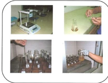
ภาพที่ 10 คู่มือการปฏิบัติงาน เรื่องวิธีการทดสอบปริมาณสิ่งสกปรกในยางแท่ง
