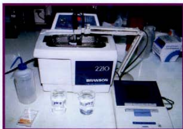
การวัดค่า pH ของน้ำฝน โดย pH meter ที่ 25 °C
